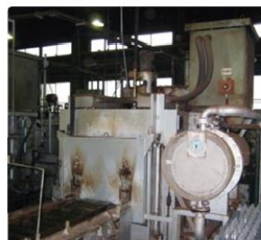
浸炭焼入れの様子
